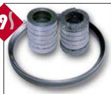
АУК подбираются согласно размеров для конкретного типа арматуры; состоят из уплотняющего комплекта штока и уплотнения крышки. Для энергетической арматуры старого типа прилагается дополнительно пакет из компенсирующих колец, изготовленных по специальной технологии из эластичного графита. Стандартное исполнение – комплект для уплотнения штока WGR 880 R / 950 и самоуплотняющееся кольцо Grafmet® 962 для крышки, а для крышек с фланцевым соединением – набивки как в спецификации производителя.
